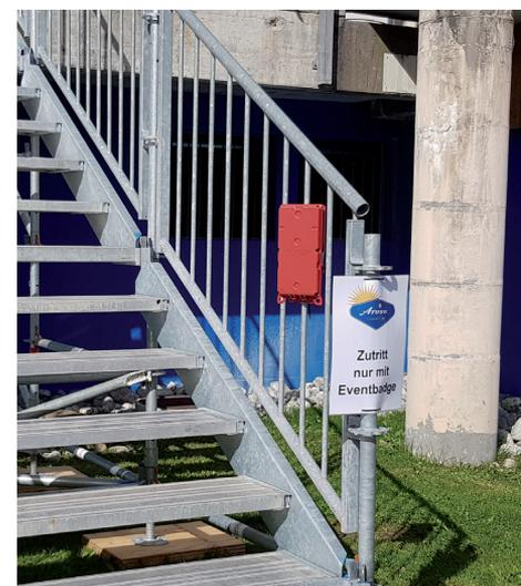
**Durch RFID-Chips in den Badges und Trackboxen auf dem Gelände konnte die Anzahl der Personen innerhalb einer Zone ständig live ermittelt und an die Leitstelle weitergegeben werden.**
